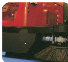
Der Seitenbesenarm ist pendelnd aufgehängt
