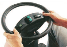
Alle Bedienelemente befinden sich direkt am Lenkrad
