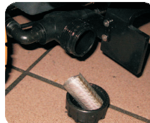
Frischwasserfilter leicht zugänglich und zu reinigen
