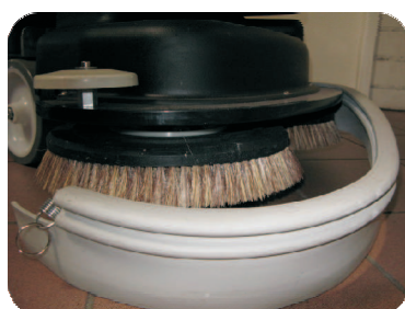
Werkzeuglos abnehmbarer Spritzschutz für die Reinigung
