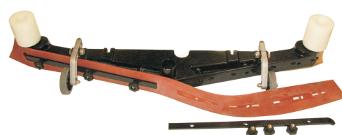
Der 90 cm breite, V-förmige Saugfuß kommt durch Türen hindurch. Die Höhe und Neigungswinkel lassen sich ganz einfach für unebene Böden einstellen. Die Gummileisten sind werkzeuglos abmontierbar und sind auf allen vier Kanten verwendbar
