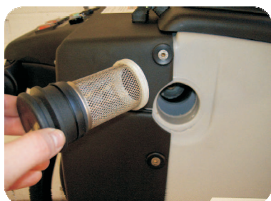
Zugänglich und einfach zu reinigen ist der Ansaugfilter für den Saugmotor
