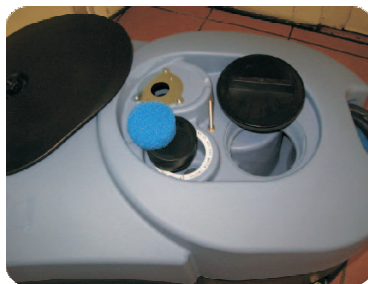
Der Ansaugfilter sowie der Schmutzwassertank ist für die Reinigung leicht zugänglich
