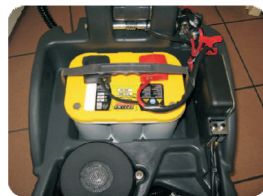
Für den leichten Transport sind Tank und Batterie werkzeugslos abnehmbar
